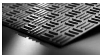
Zur Gestaltung von Wartungswegen auf Rhepanol hfk. Rutschhemmende und lastverteilende Wirkung. Einfache Fixierung durch Heißluftverschweißung. Gesamtdicke 9 mm, davon 4 mm Noppenhöhe.
