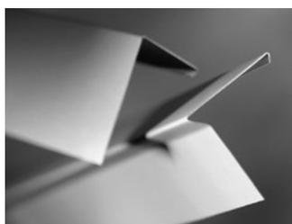
Ein mit Rhenofol C kaschiertes, feuerverzinktes Stahlblech mit rückseitig schwarzer Schutzlackierung. Zum Herstellen von Profilen für An- und Abschlüsse und Fixierungen. Können wie verzinkte Bleche geschnitten und gekantet werden. Weitere FDT-Standardfarben auf Anfrage (Blechdicke: 0,6 mm, Beschichtung: 0,6 mm). Für den Anschluss von Rhenofol CG- und Rhenofol CV-Dachbahnen.
