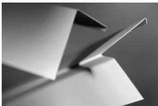
Mit Rhepanol h kaschiertes, feuerverzinktes Stahlblech mit rückseitig grüner Schutzlackierung. Zum Herstellen von Profilen für An- und Abschlüsse. Können wie verzinkte Bleche geschnitten und gekantet werden. Alle Rhepanol-Dachbahnen können mit Rhepanol-Anschlussblech verbunden werden (Blechdicke: 0,6 mm, Beschichtung: 0,6 mm).
