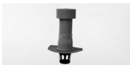
Aus erhöht schlagzähem PVC hart. Lüftungsquerschnitt von 114 cm<sup>2</sup>. Die auf die FDT Dunstrohrhaube aufgesteckte FDT Wetterkappe kann zu Wartungszwecken abgenommen werden. Einbaufertig mit integrierter Manschette. Korpus: grau. Höhe Kondensatschale: 14 cm.
