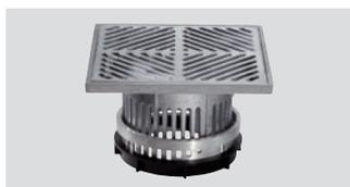
Aus Aluminium, bestehend aus Liftring und Distanzring. Für die Ausführung von Flachdächern mit Plattenbelägen und von Umkehrdächern. Die Einbauhöhe von 67 bis 90 mm kann dem Terrassenaufbau in 3-mm-Abstufungen angepasst werden. Ab einer Belagshöhe von 90 mm sind zusätzliche FDT Liftringe erforderlich. Abmessung 195 x 195 mm für Raster 200 x 200 mm.
