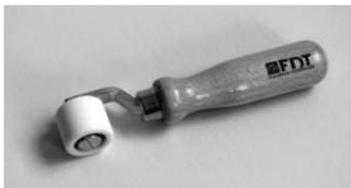
3 cm breit. Zum Anrollen von heißluftverschweißten Nähten bei Rhepanol-Dachbahnen.
