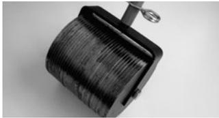
Zum Anrollen der Vlieskaschierten Rhepanol hfk in den Rhepanol-Klettstreifen Gripfix.
