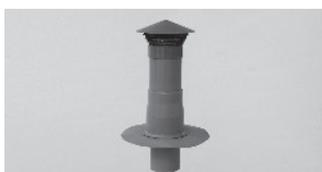
Aus erhöht schlagzähem PVC hart. Mit abnehmbarer Haube und einbaufertiger, integrierter Manschette zum Anschluss an die Dachbahn. Ermöglicht bei einer Dachsanierung den bündigen Anschluss der Dachabdichtung an ein abgesägtes Lüftungsrohr DN/OD<sup>2)</sup> 100/110. Korpus: grau. Maßketten: Ø ausgehendes Rohr 10,2 cm, Höhe ausgehendes Rohr 12,0 cm.
