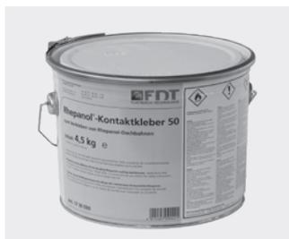
Zum Ankleben von Rhepanol-Dachbahnen an Beton, Holz, Polyester, Stahl etc. Nicht geeignet für die Verklebung auf Polystyrol. Verbrauch: ca. 500 g/m<sup>2</sup> (250 g/m<sup>2</sup> pro Seite). Mindestens 2 Jahre lagerfähig.
