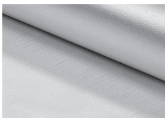
Gewebeverstärkte und selbstklebende Alu-Verbundfolie nach DIN 18234.  $s_d > 1.500$  m (praktisch dampfdicht). Brandklasse B2 bzw. Klasse E.
