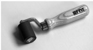
4 cm breit. Zum Andrücken der zu verbindenden Rhepanol-Dachbahnen beim Heißluftverschweißen.
