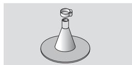
Für den Anschluss der Dachbahn an Stützen und Sekuranten ab 14 mm bis 50 mm Durchmesser mit Edelstahlschelle für Durchmesser 14 bis 16 mm. Flanschdurchmesser: 160 mm. Höhe: 15 cm.
