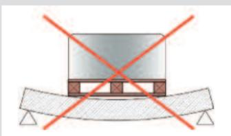
Die Tragfähigkeit der Decke prüfen. Besondere Vorsicht bei Trapezblech- und Holzkonstruktionen. Es besteht Einsturzgefahr!
