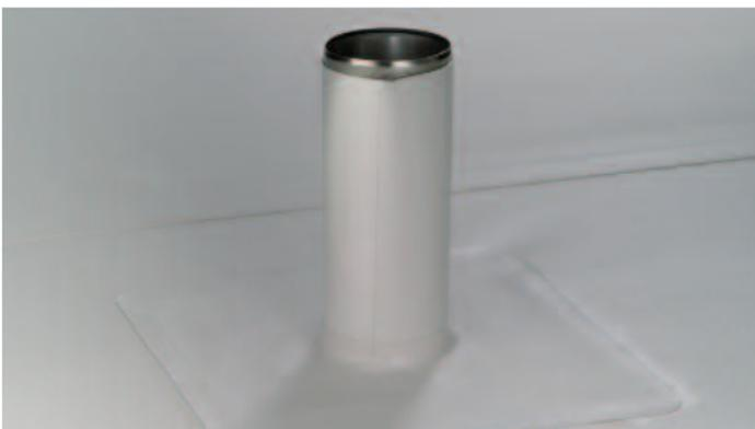
Fertiggestellte Einfassung mit Manschette und Warmformflansch. Oberen Abschluss gegen Wasserhinterläufigkeit sichern, z. B. mittels Edelstahlschlauchselle plus Versiegelung.
