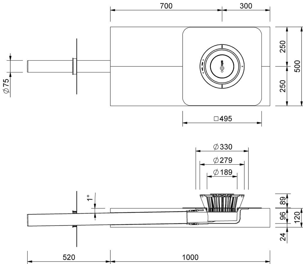
SitaIndra Hauptentwässerung, mit Bitumen-Manschette
