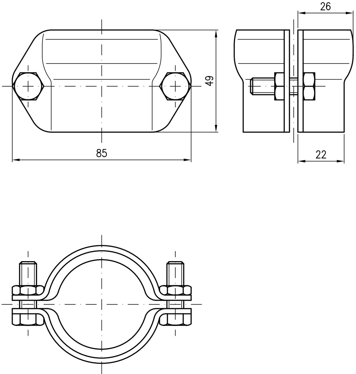
Werkstoff: Feuerverzinktes Spaltband DX51D+Z 275 MA C
