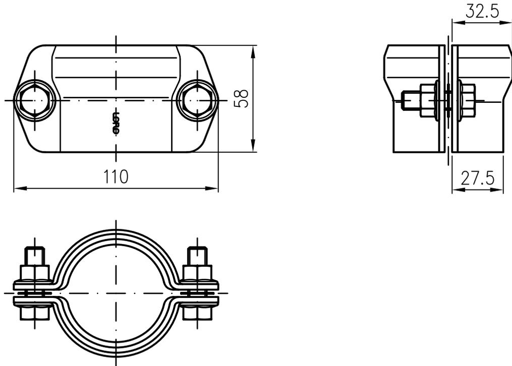
Werkstoff: Feuerverzinktes Spaltband DX51D+Z 275 MA C
