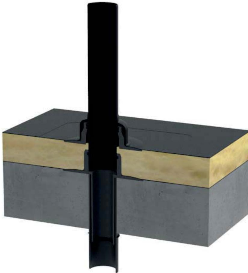
Sanierungslüfter in altem Rohr eingebaut. Zur Überbrückung der Wärmedämmung wird auf der wasserführenden Ebene ein Klebekragen eingesetzt.
