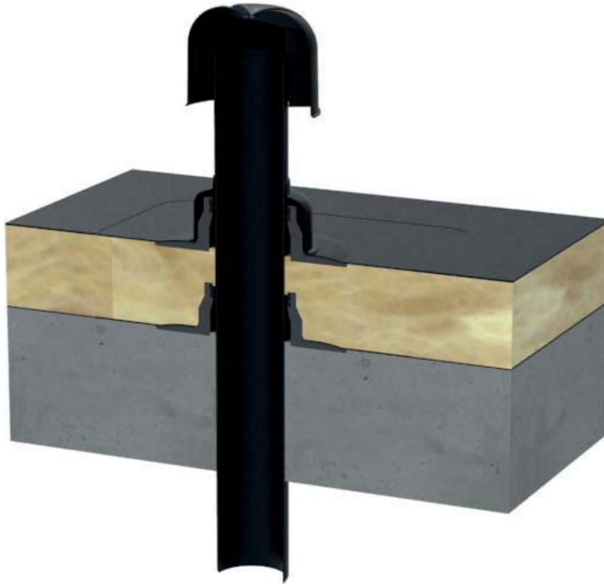
Lüftungsrohr aus PE im Warmdach verbaut. Die wasserdichte Durchführung wird durch zwei Klebekragen gewährleistet. Auf der wasserführenden Ebene schützt der Wasserabweiser die eingebauten Lippendichtungen vor UV-Licht bzw. stehendem Wasser.
