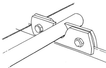
Die Aufstockelemente werden seitlich an die Schneefanglaschen eines neuen bzw. schon bestehenden Einfachrohr-Schneefangs montiert.
