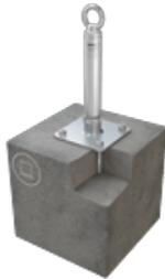
Eine starke Stütze für Betonuntergründe: Das ist der Einzelanschlagpunkt ABS-Lock X-SR-B mit Grundplatte (150 x 150 mm) und einem verschweißten Stützrohr (Ø 42 mm). Sie befestigen den Sekuranten einfach mit 4 Einschlagdübeln auf der Dachhaut oder an der Fassade. Die Einbautiefe beträgt nur 65 mm. Die Kerbung des Stützrohrs dient als Sollknickstelle und sorgt bei einer Sturzbelastung für ein genau definiertes Umknicken in Belastungsrichtung.
